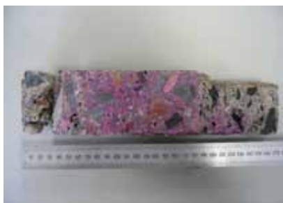
Test betonu na obsah pH pomocí fenolftaleinu
