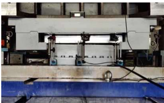
Zkouška ložisek TETRON® DC-SB pro souběžný tah a pootočení v testovací laboratoři ISOLAB
